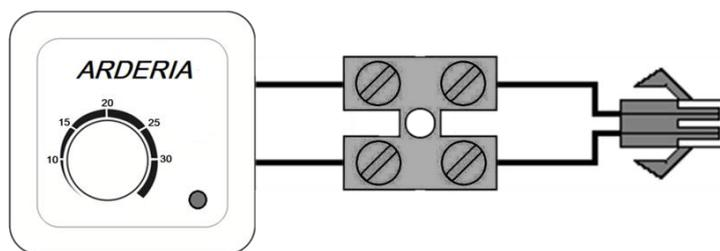
Рис. 46 Подключение комнатного термостата к клеммной колодке
