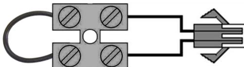
Рис. 47 Подключение перемычки (шунта) к клеммной колодке
