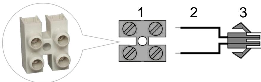
Рис. 45 Подключение клеммной колодки к разрезанным проводам перемычки.
