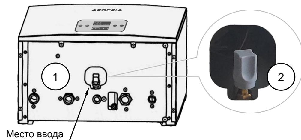
Рис. 50 Место ввода соединительных проводов комнатного термостата в котёл.
