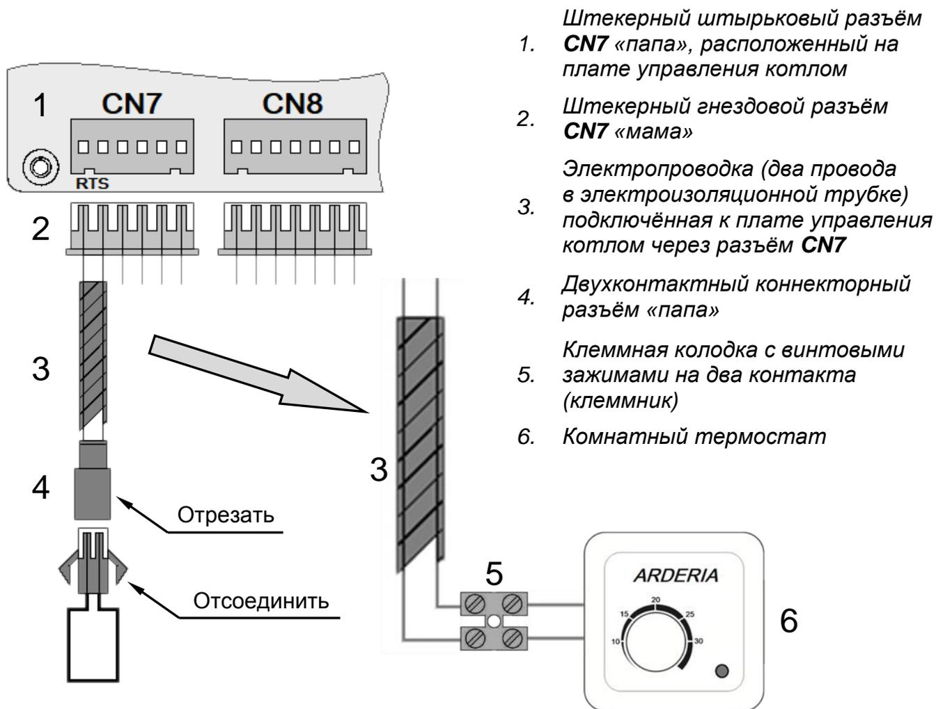
Рис. 48 Принципиальная схема подключения комнатного термостата непосредственно к электропроводке (двум проводам в электроизоляционной трубке) присоединённой к плате управления котлом через разъём CN7
