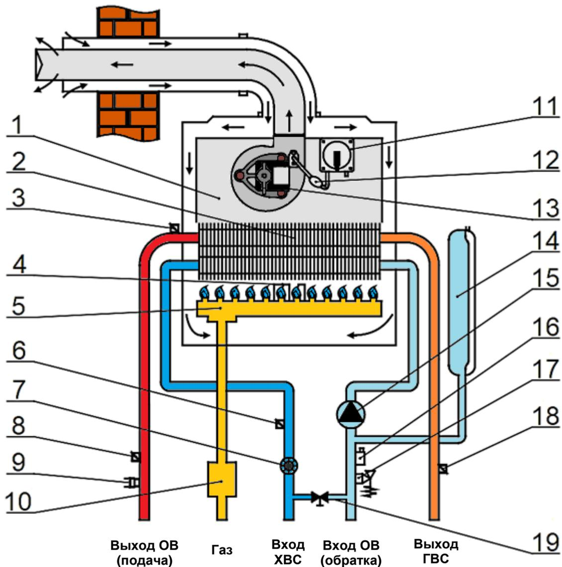
Рис. 1 Функциональная схема котла серии Arderia B
