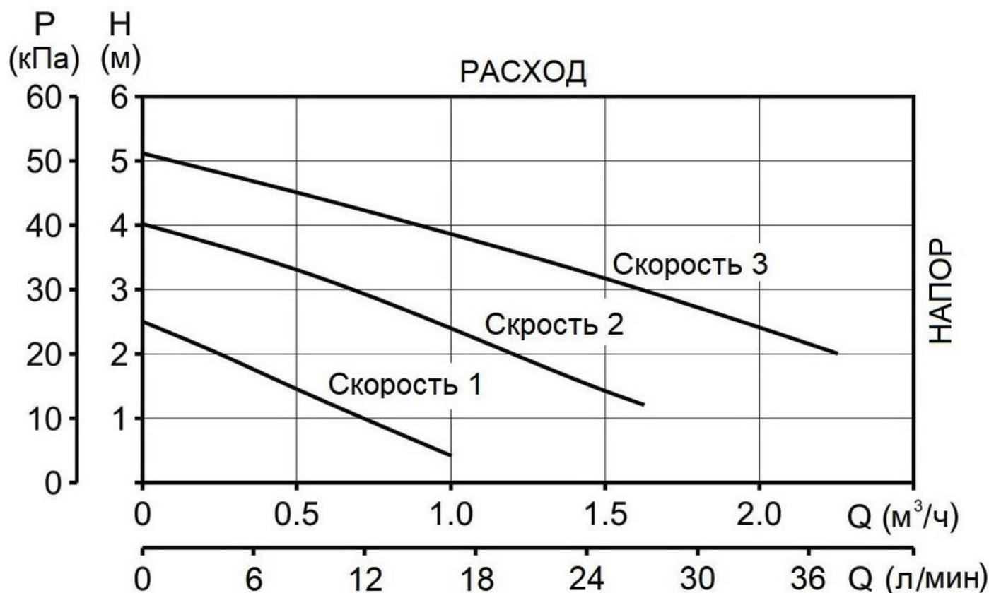
Рис. 23 Напорно-расходные кривые циркуляционного насоса котла.
