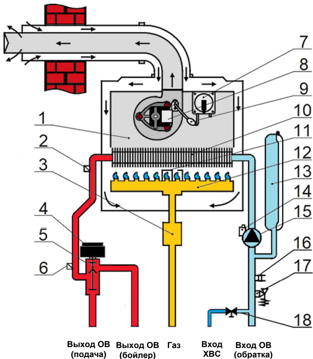
Рис. 3 Функциональная схема котла серии Arderia SB
