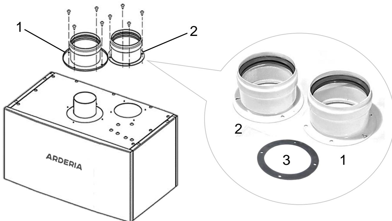
Рис. 33 Установка присоединительных фланцевых элементов для подключения раздельной системы дымоудаления Ø 80x80 мм.
