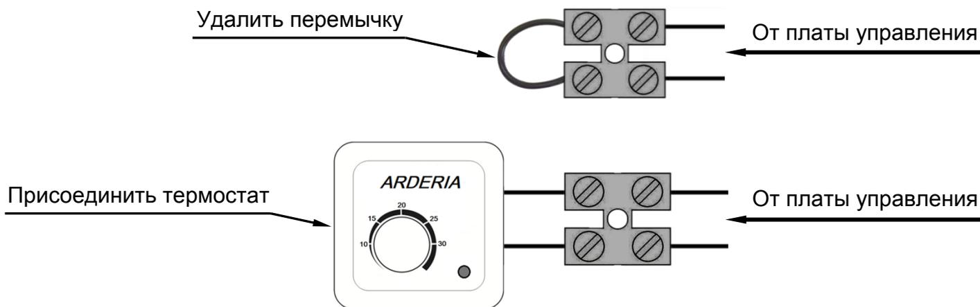
Рис. 49 Подключение комнатного термостата к двухконтактной клеммной колодке
